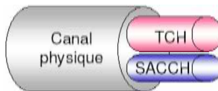
Figure. I.14. Représentation symbolique d'un canal physique supportant un canal de trafic (TCH) et un canal associé (SACCH).
