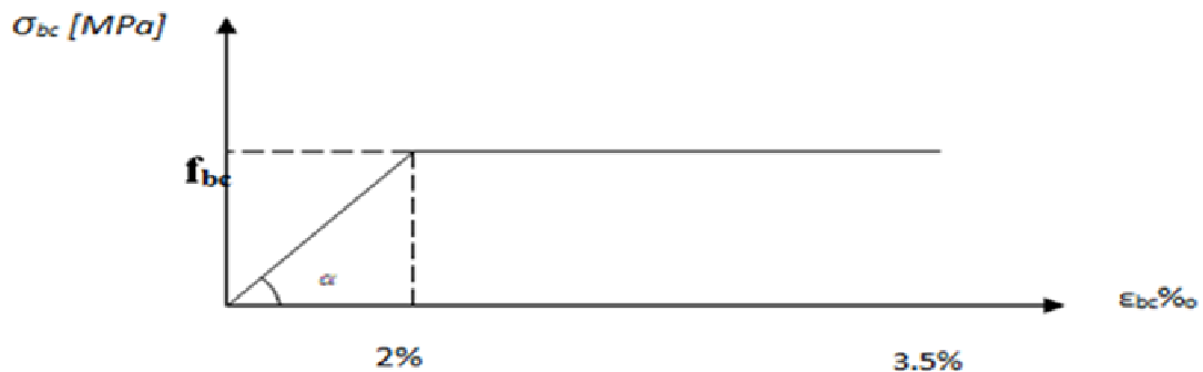
Figure. I. 5 : Diagramme Contrainte-déformation du béton à l'ELS
