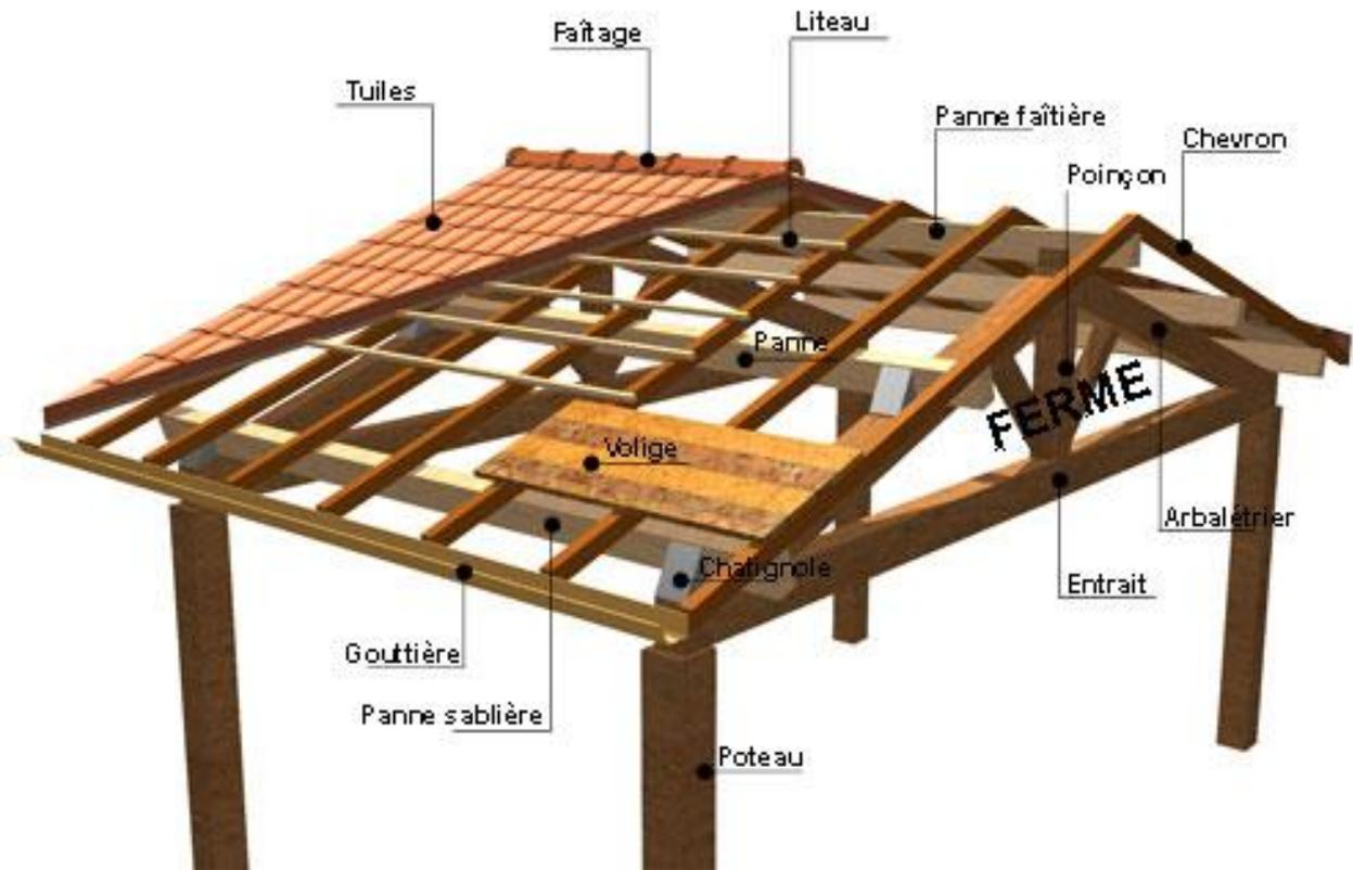
Figure III-8- 1 : les éléments de la charpente
