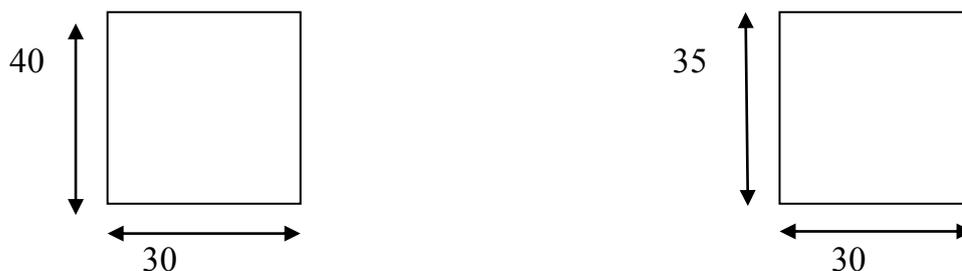
*Figure II 06 : les dimensions des poutres principales et secondaires*
