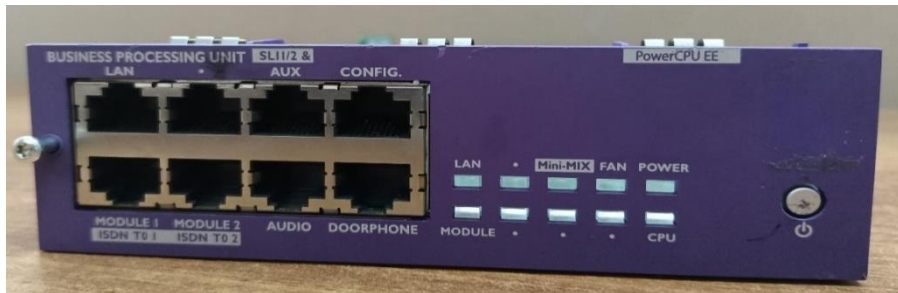
Figure 21: Exemple de carte CPU Power EE.
