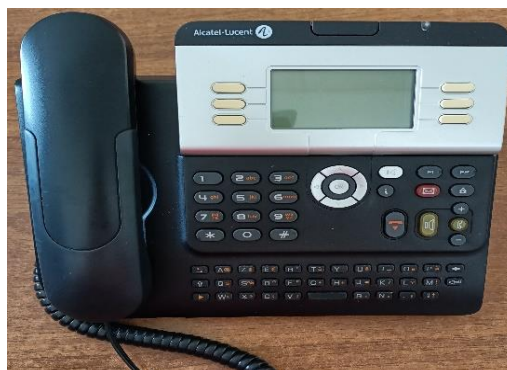
Figure 26: le poste opérateur numérique 4029.
