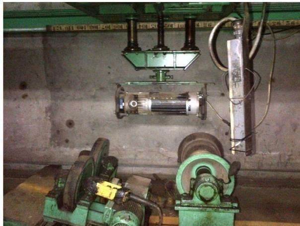
Figure III.13 : Générateur de rayons X yxlon smart
