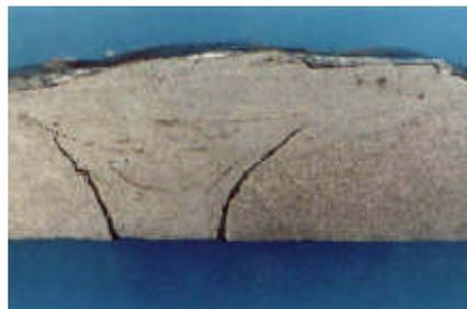
Figure II.17: Fissure à froid. [14]
