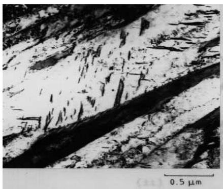
**Figure I.11 : Bainite inférieure**
