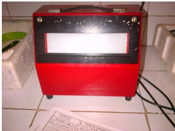
**Figure III-15. Négatoscope kowolux 4s (pour observation des défauts)**
