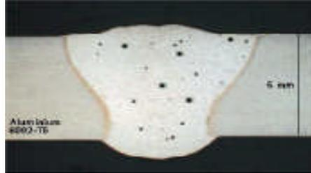
**Figure II.19 : Soufflures sphéroïdales non débouchantes [14]**
