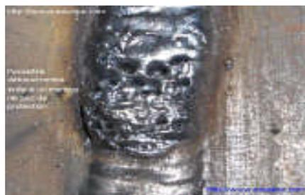
Figure II.18: Porosités débouchantes en surface de cordon de soudure [14]
