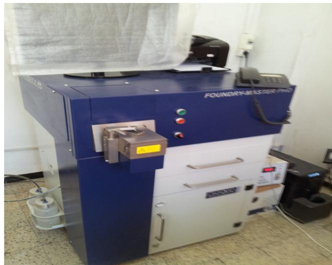
Figure III.1 : Spectromètre à émission optique (FOUNDRY-MASTER Pro)
