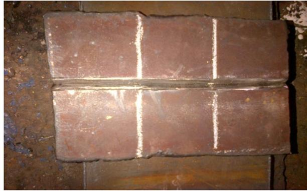
Figure III.3 : Soudage mono-passe
