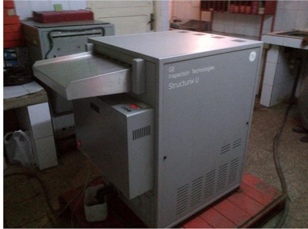
**Figure III.14 : Développeuse de film radiographique (AGFA structurix U)**
