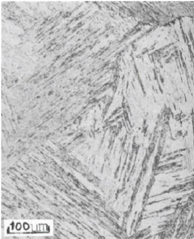
Figure I.13 : Martensite en aiguilles
