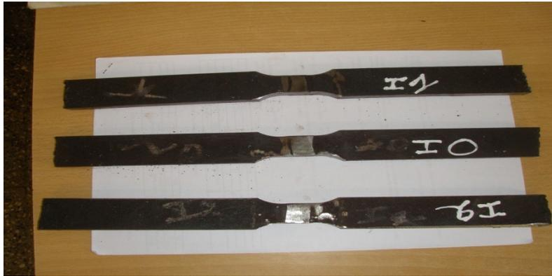
Figure III.5 : Eprovettes de traction
