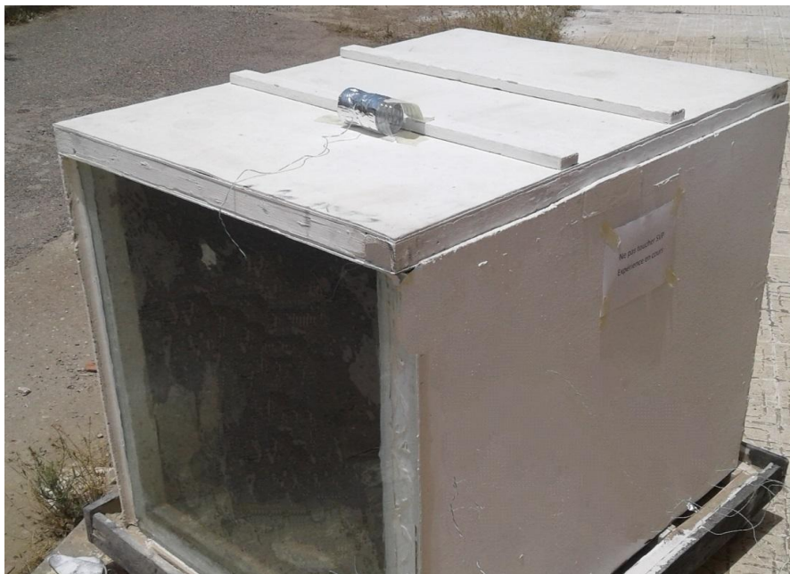
Figure III. 26 : Cabine réalisée pour faire le test thermique
