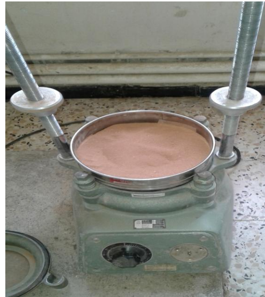
Figure III. 8 : Tamisage de la poudre
