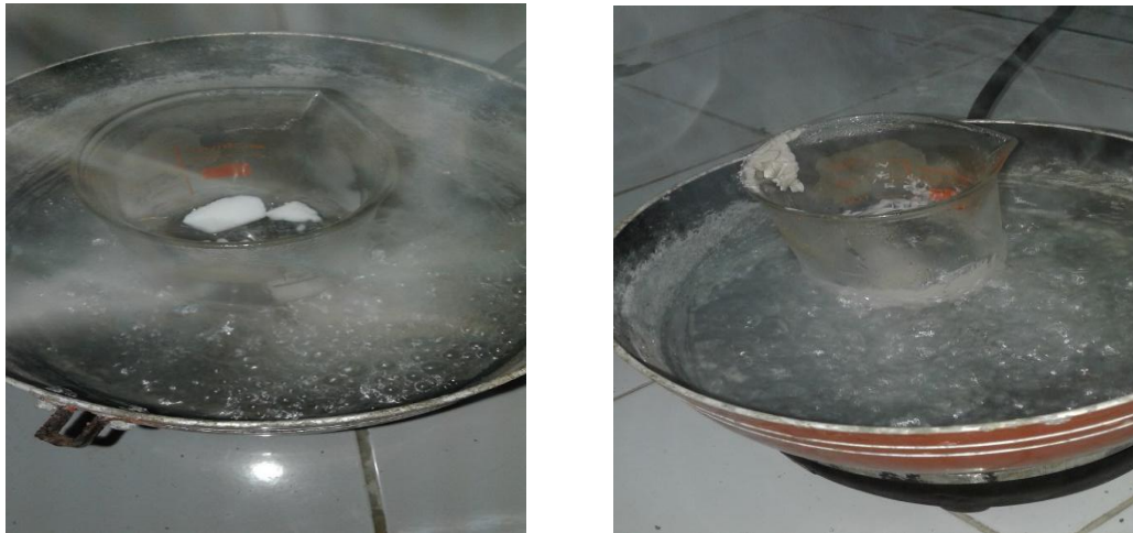
Figure III. 12 : Fusion du MCP et Mélange homogène des différents constituants du composite
