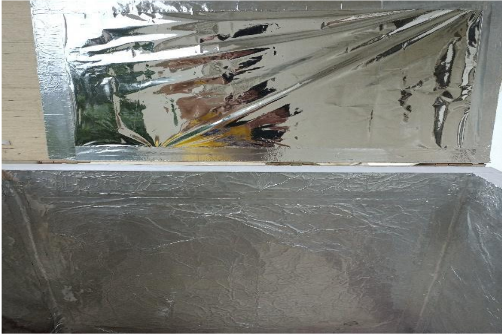
Figure III. 30: Revêtement des parois intérieures avec des feuilles en aluminium
