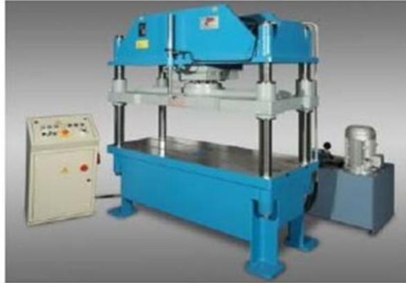
**Figure 6 Presse Hydraulique**
