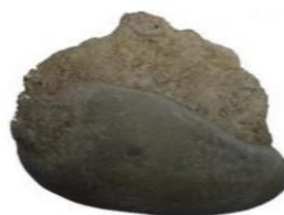
Figure 1 9: un granulat recyclé (granulat naturel entouré de mortier adhérent)
