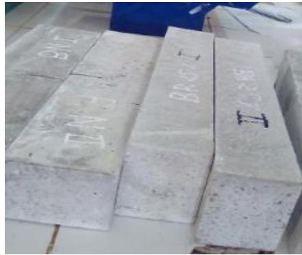
Figure 1 15: poutre de flexion
