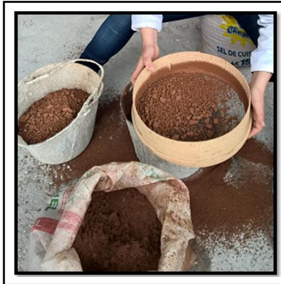
Figure04 : Tamisage des particules de brique en deux textures, une fine et une autre grossière.
