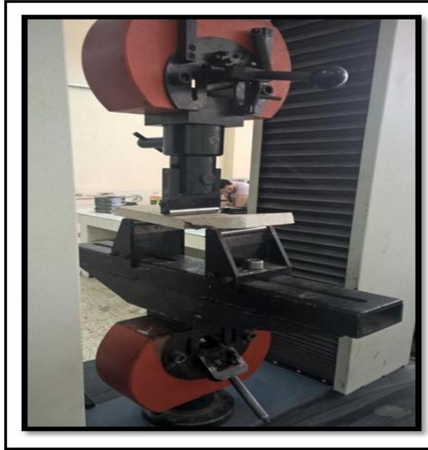
Figure 15 : photos montrant la fissuration de l'éprouvette sous l'effet de la force des 3 point
