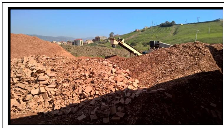
Figure 36 : broyage des déchets de briques
