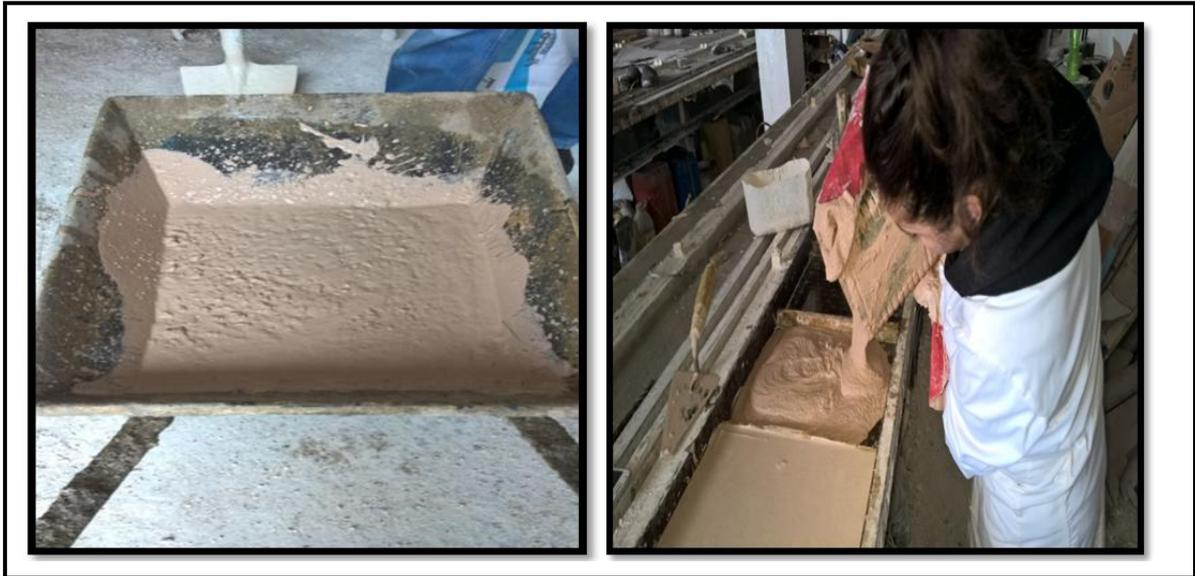
Figure 07 : homogénéisation de la pâte et la mise en moules
