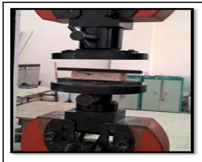
Figure 19 : Echantillon entre deux plaques métalliques prêt à la compression.
