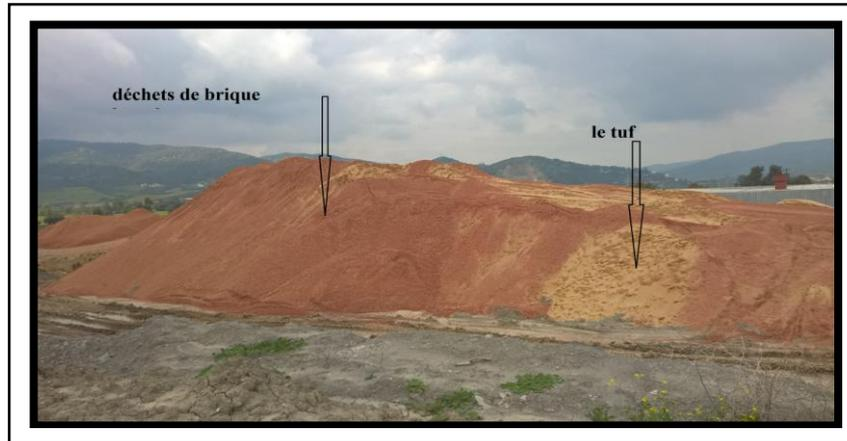
Figure 37 : mélange de déchets de briques avec le tuf
