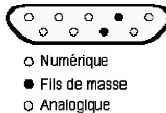
**Fig 29 : Placement des câbles dans un connecteur**
