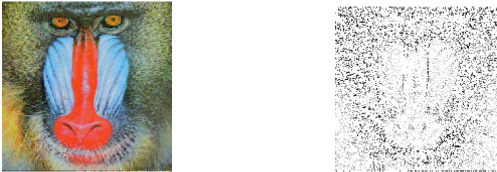
Figure II.5 : Détection de contour par le modèle de Canny-Dérivée
