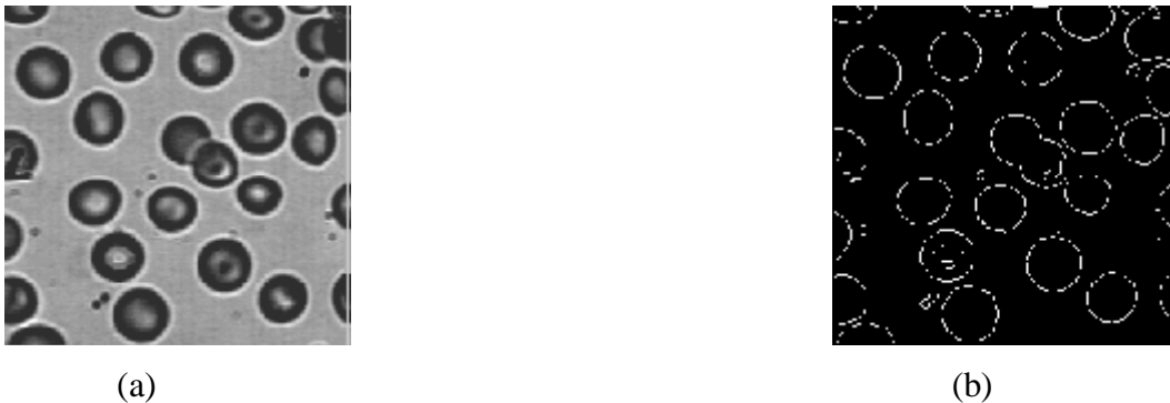
Figure II.4 : Illustration de la détection de contours. (a) Image originale ; (b) Détection des contours par une méthode dérivative.
