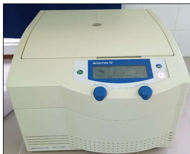
Photographie d'une Centrifugeuse non réfrigérée, max 12.927 x g(SIGMA)
