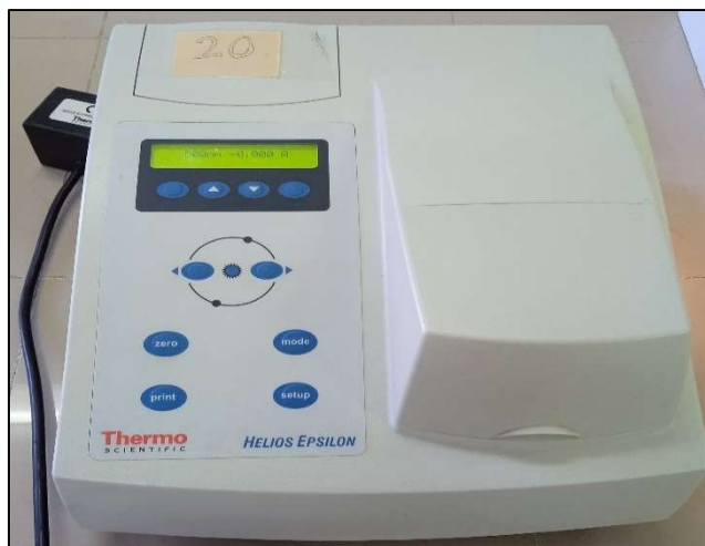
Photographie d'un Spectrophotomètre UV-Visible (HELIOS EPSILON)
