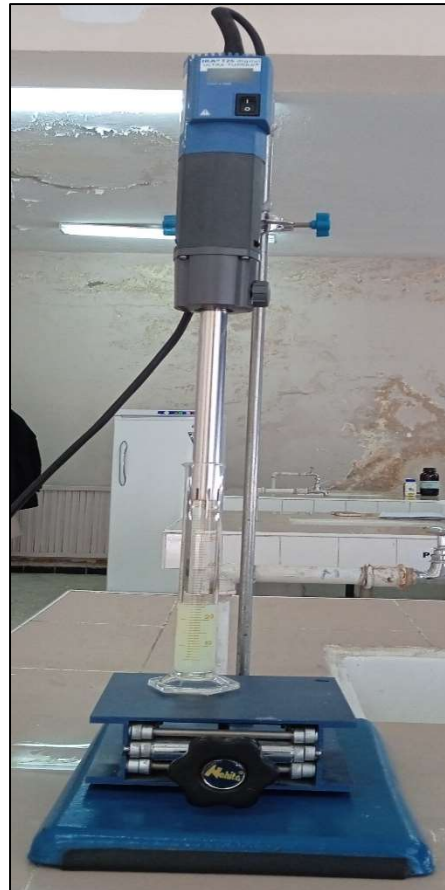
Photographie d'un Homogénéiseur à tige (ULTRA-TURRAX)
