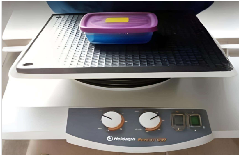
Photographie d'un Agitateur orbital (Heidolph Duomax 1030)
