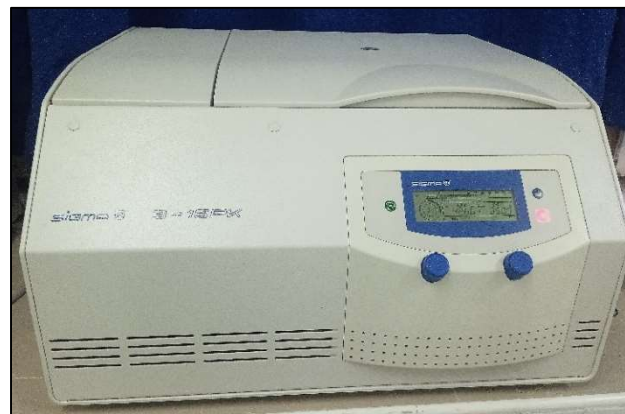
Photographie d'une Centrifugeuse réfrigérée, max 28000 x g (SIGMA)
