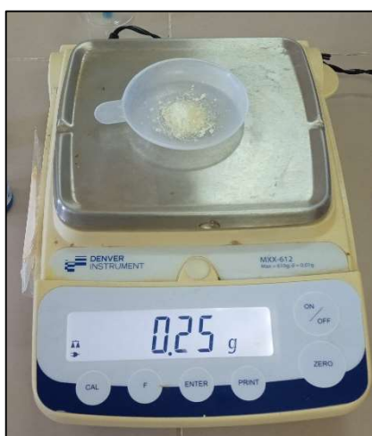
Photographie d'une Balance de précision, max 610g (DENVER)
