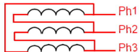
b) Montage triangle 3 fils en alternatif
