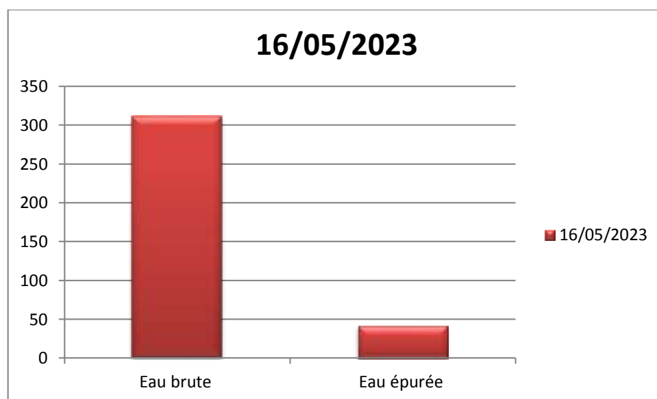
Figure 29 : Variation de la teneur de la DCO de l'eau brute et épurée de la station STEP Est Tizi-Ouzou en mg.l -1
