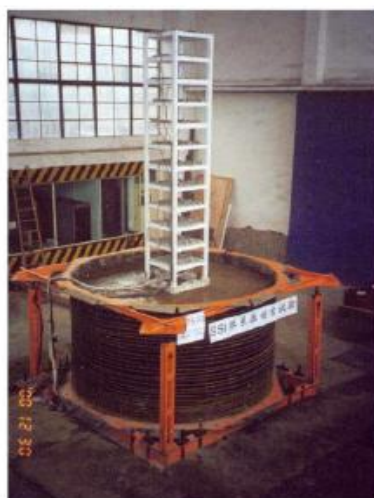
Figure 2.5 : Photographie d'un modèle prototype pour le test sur table vibrante (Lu et al. 2004).
