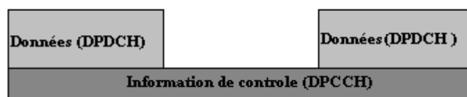
Figure II.14 : Transmission en parallèle des canaux DPDCH et DPCCH
