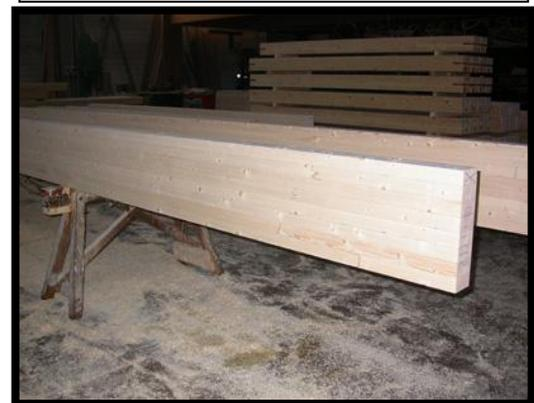
Figure 8: Rabotage et finition.
