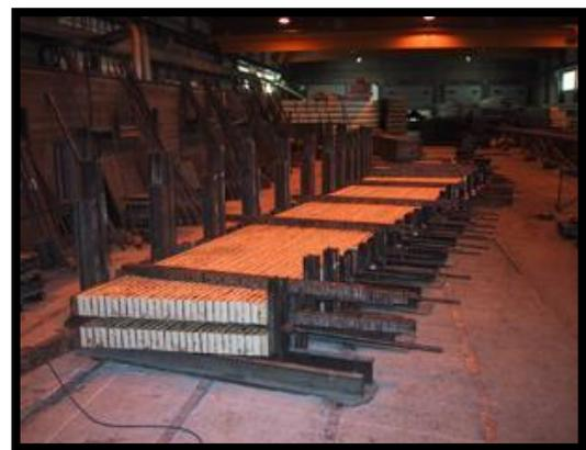
Figure 7: Aboutage et pressage des pièces de bois.
