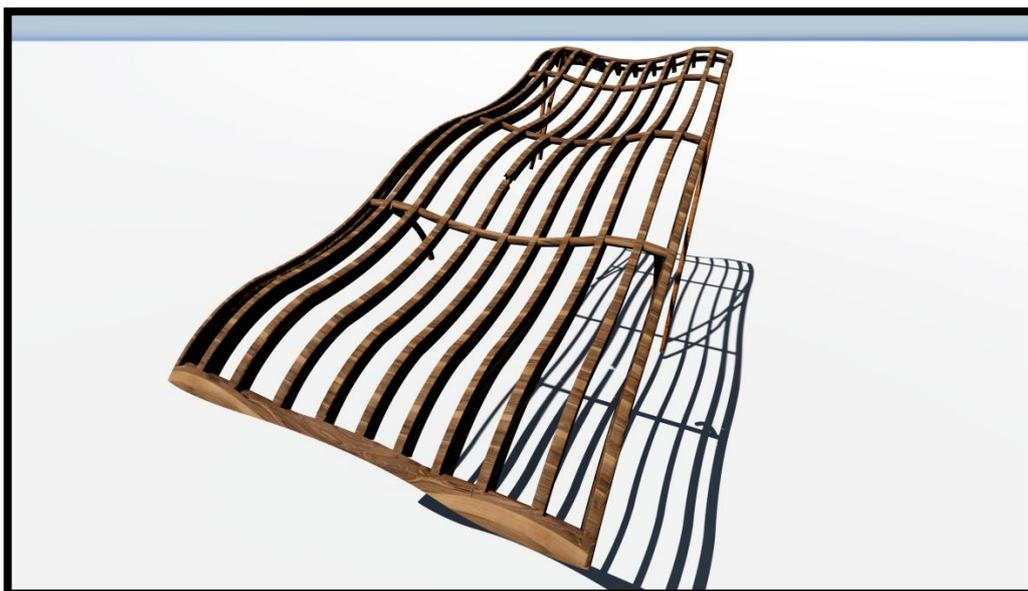
Figure 13: L'ossature de l'ombrière au-dessus de l'administration.
