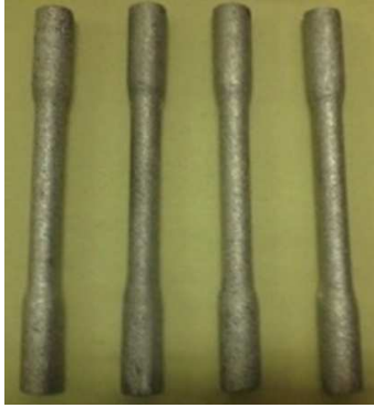
Figure II.1.13 - Eprouvettes en sable
