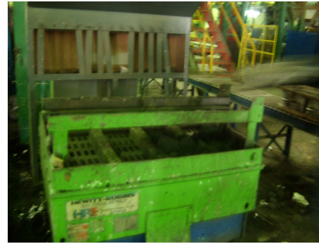
Figure II.1.8 - Poste de démoulage
