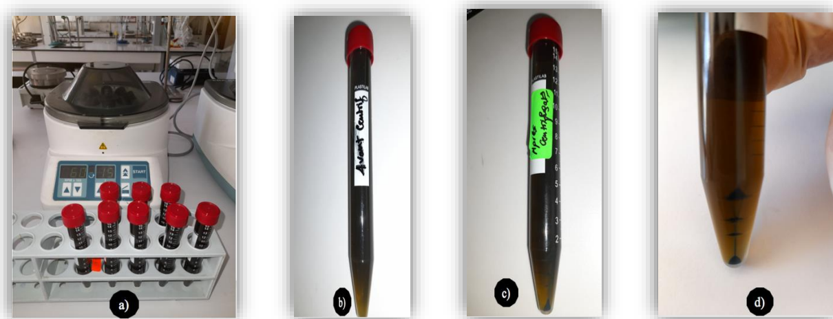
Figure 16 : a) Préparation à la centrifugation ; b) L'extrait avant centrifugation ; c) Extrait après centrifugation ; d) Zoom sur la précipitation de l'extrait.
