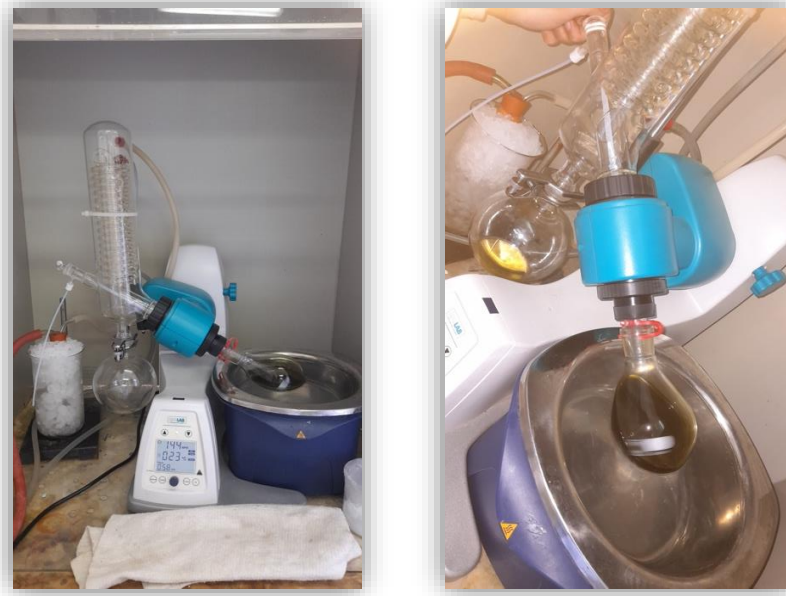
Figure 17 : Élimination du solvant à l'évaporateur rotatif.
