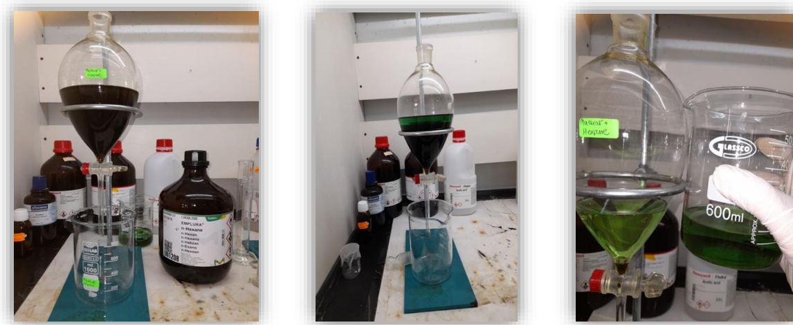
Figure 15 : Traitement du macérât (hydro éthanolique) avec l'hexane
