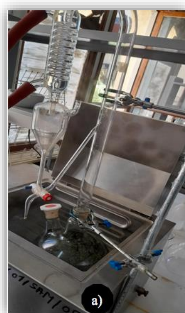
Figure 10 : Montage d'Hydrodistillation au bain-Marie.
