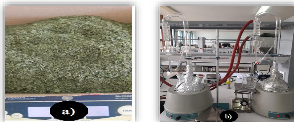
Figure 9 : a) MV d' Urtica dioïca broyée grossièrement ; b) Montage d'Hydrodistillation Clevenger.
