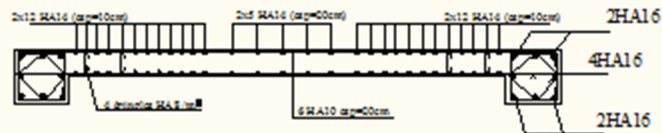
Ferrailage de voile longitudinal 5 zone I
