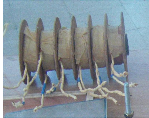
Figure II.5 : moteur linéaire tubulaire réalisé au niveau du laboratoire d'E.E (1)
