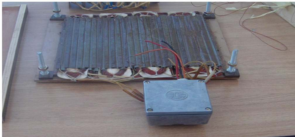
Figure IV.5 : Model machine linéaire asynchrone réalisée par des étudiants en entraînements électriques
