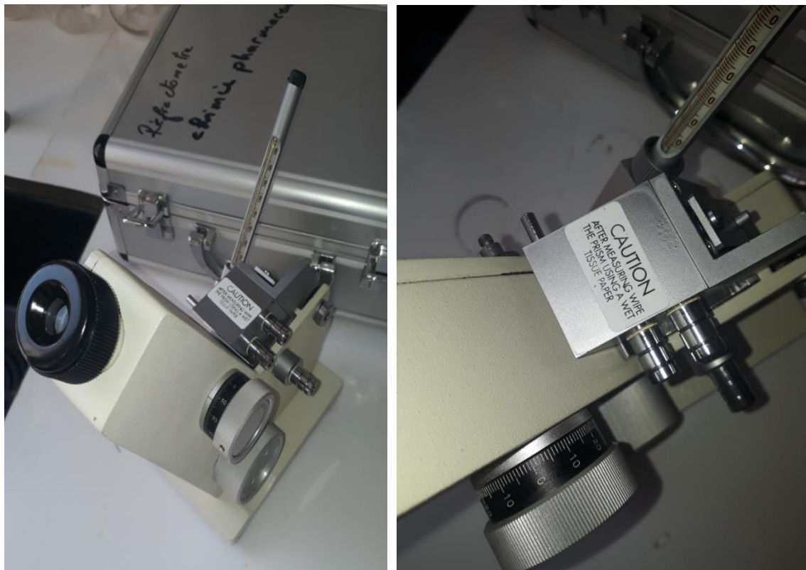
Figure 11 : Réfractomètre utilisé pour la mesure de l'indice de réfraction et le degré de Brix.
