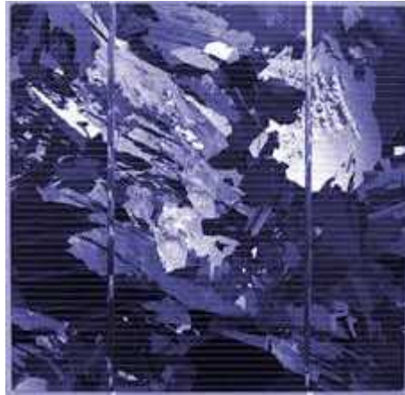
Figure IV-6 : Cellule en silicium poly-cristallin. [10]
