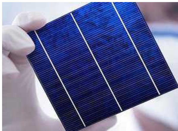
Figure IV-5 : cellule en silicium monocristallin. [10]
