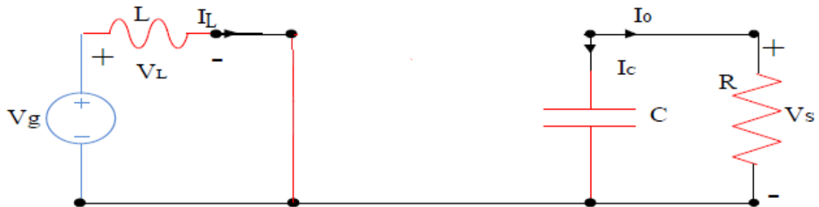
Figure III.4 : Circuit équivalent du hacheur parallèle quand S est fermé
