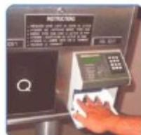
**FIG. I.5- Dispositif de reconnaissance par géométrie de la main**
