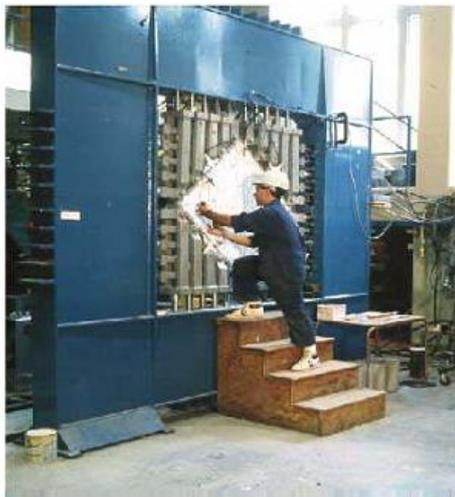
Figure 1.10 . Dispositif expérimental pour les essais de cisaillement (Univ. of Toronto)
