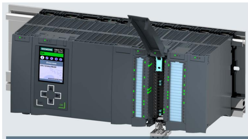
Figure IV.7. Automate S7-1500 de SIEMENS.
