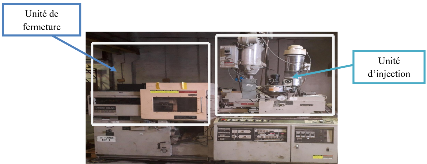
Figure I.4. Les différentes unités de la machine.
