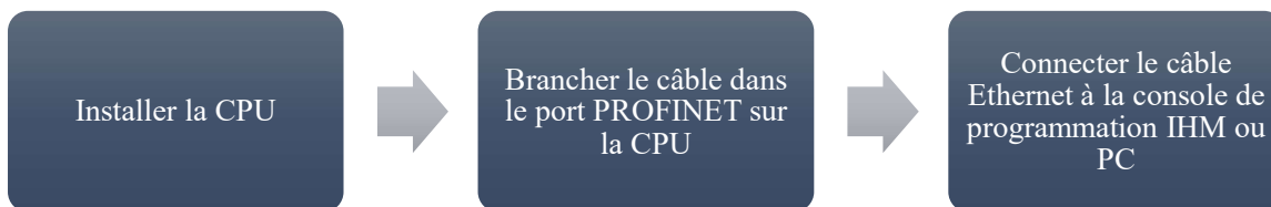
Figure III.23. Les étapes de création de la liaison réelle avec PROFINET.
