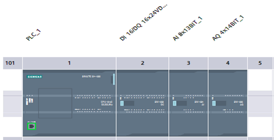
Figure III.15. La configuration matérielle de notre projet.
