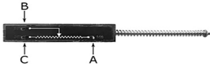
Figure II.6. Le fonctionnement d'un potentiomètre linéaire.
