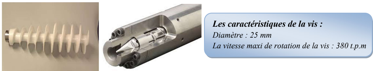
Figure I.12. La vis d'injection, sa structure interne et ses caractéristiques.
