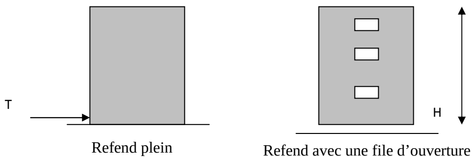
Fig :V- 2 :Refend à ouvertures assimilé à un refend plein
