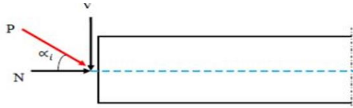
Figure VI. 3 : composantes de la force de précontrainte
