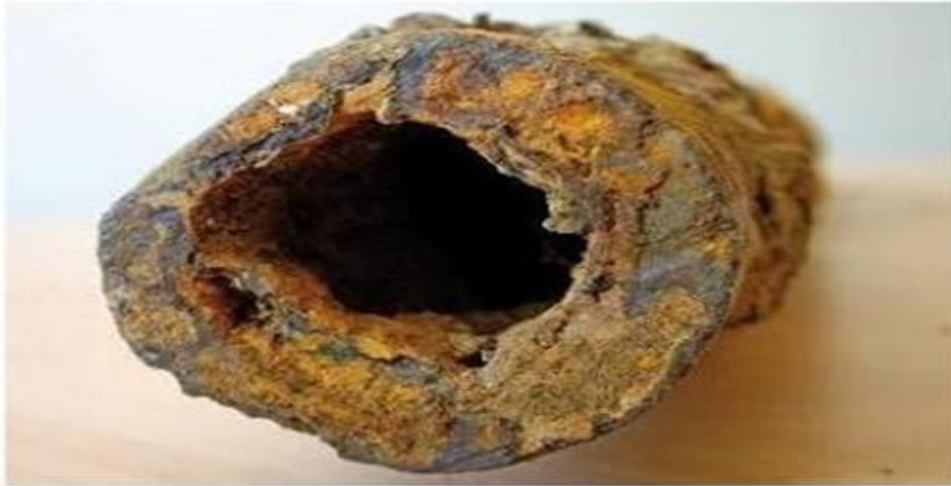
Figure I.12 : Vieillissement des conduites [IKHLEF & HALICHE, 2018].
