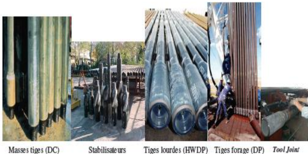
Figure. I.4) : Exemple de quelques éléments de la garniture de forage
