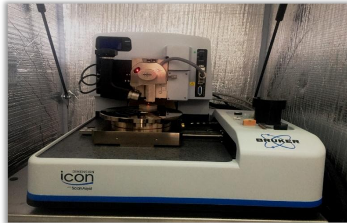
Figure II.8 Microscope à force atomique utilisé.
