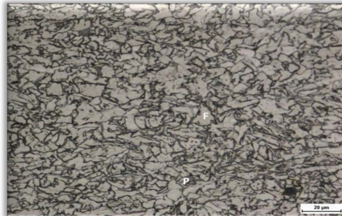
Figure II.1 Observation au microscope optique de l'acier X60.
