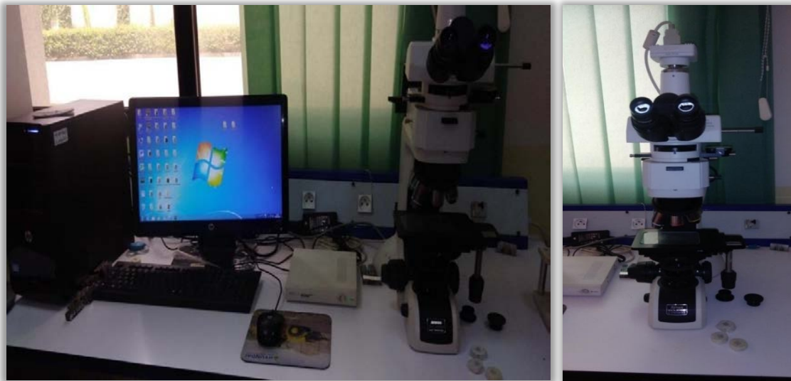
Figure II.7 Microscope optique utilisé.
