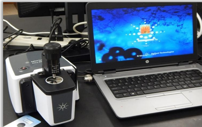
Figure II.9 Spectromètre FTIR-ATR Agilent 630 utilisé dans cette étude.
