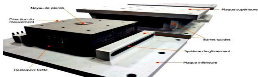
Figure IX.6: Appareil d'appui en élastomère fretté.
