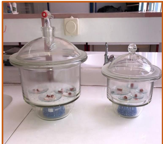
Refroidissement dans dessiccateur
