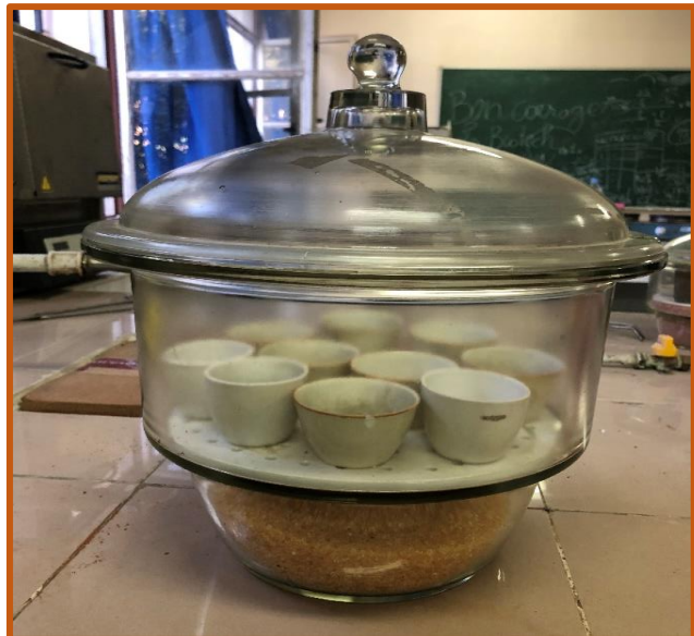
Refroidissement dans dessiccateur
