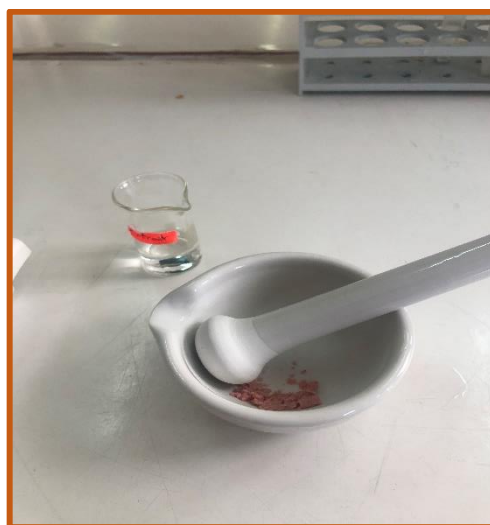
Broyage par un mortier en porcelaine.
