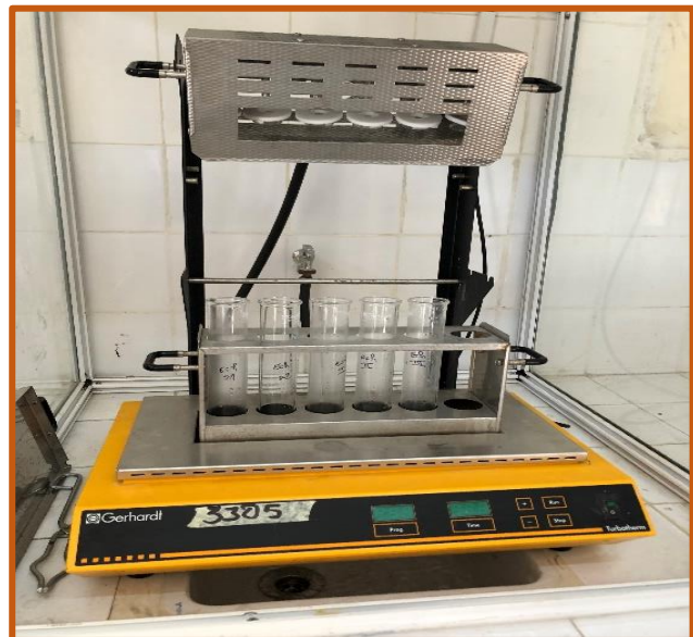
Mettre matras contenant échantillons dans minéralisateur
