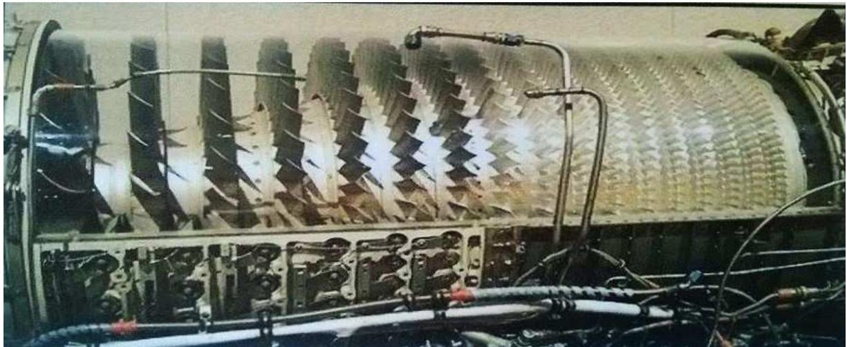
*Figure 4.2 : Compresseur (17) étages de la turbine V 94. 3A*
