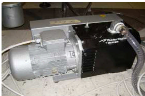
Figure I.10 : pompe à vide pour la station de moulage
