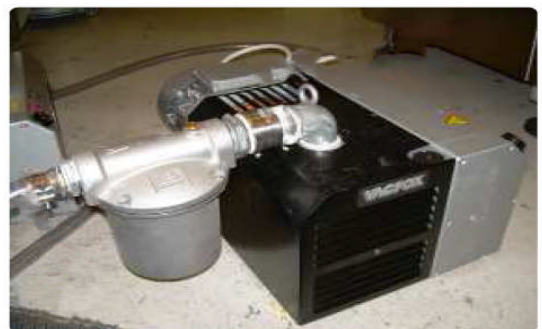
Figure I.11 : pompe à vide pour la station de soudage
