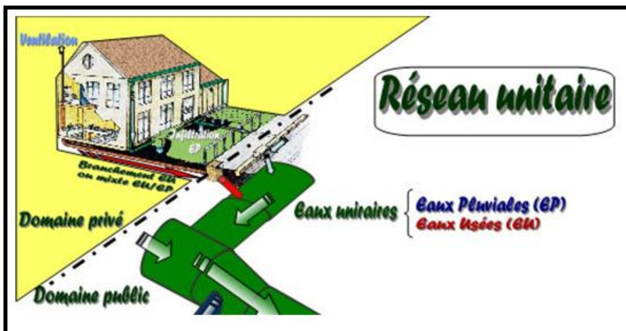
Fig 56 : schéma illustratif d'un réseau unitaire
