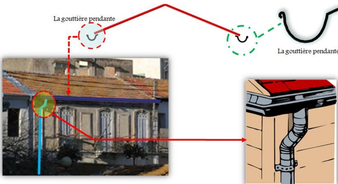
Fig 50 : Photos illustrative de la disposition d'une gouttière pendante
