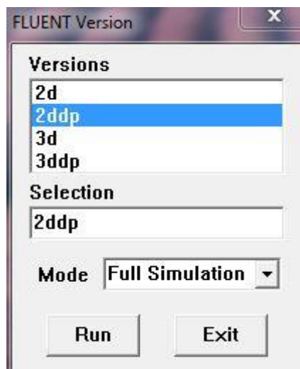
Figure III.14 : Choix du 2D, double précision sur Fluent 6.3.2
