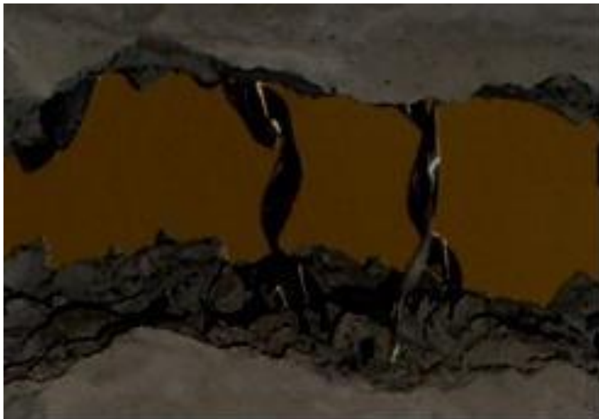
Etape 3 : les fibres ont repris totalement la charge exercée sur l'éprouvette, elles s'étirent.
