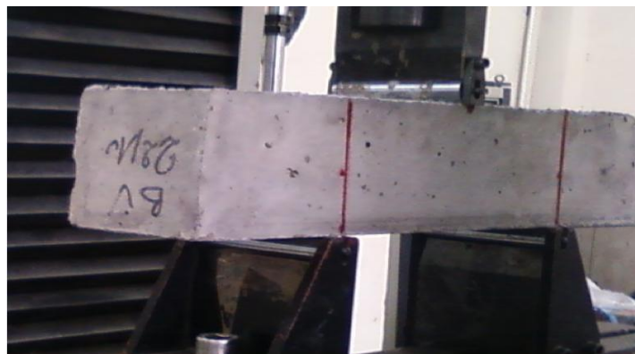
Figure II.23 : Dispositif expérimentale pour l'essai de flexion à trois points
