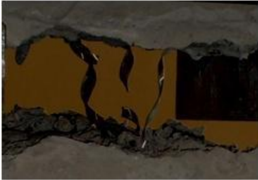
Etape 4 : certaines fibres s'arrachent et d'autres commencent à se rompre.
