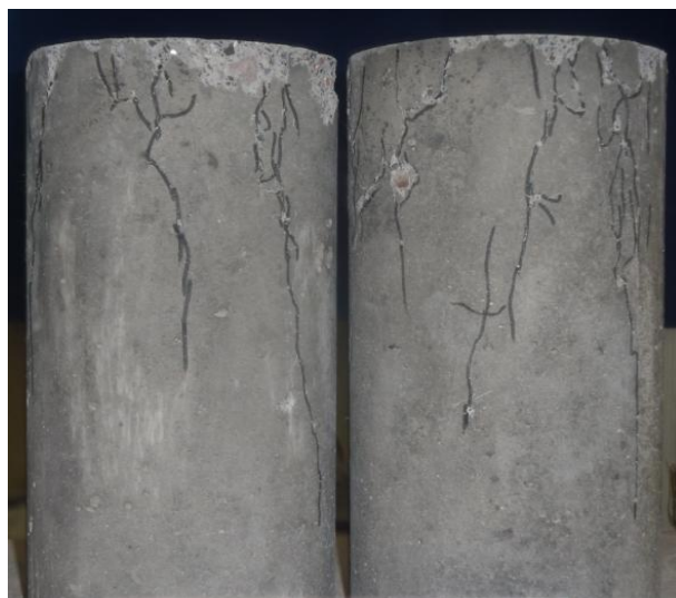
Figure II.18 : photo de l'éprouvette en béton renforcé avec W=0.6\% de fibres à 50 mm avec quatre ondulations
