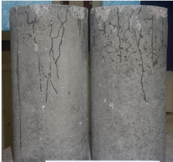
Figure II.19 : photo de l'éprouvette en béton renforcé avec W=0.8\% de fibres à 50 mm avec quatre ondulations
