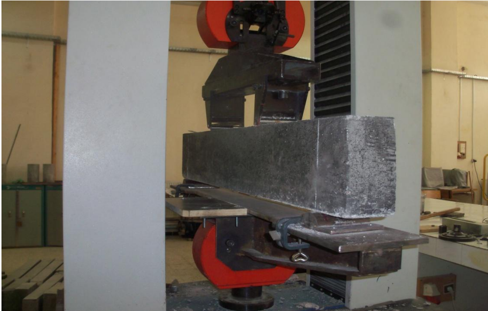
Figure II.46 : Photo du dispositif de l'essai par cisaillement
