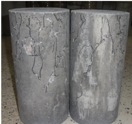
Figure II.20 : photo de l'éprouvette en béton renforcé avec W=0.6\% de fibres à 50 mm avec huit ondulations
