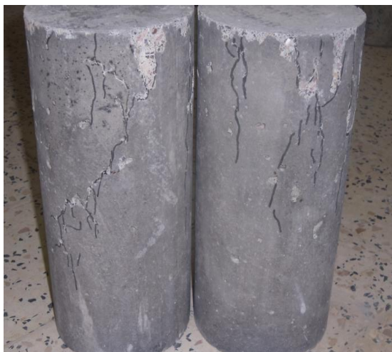
Figure II.21 : photo de l'éprouvette en béton renforcé avec W=0.8\% de fibres à 50 mm avec huit ondulations
