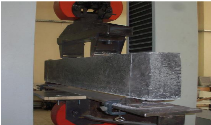
Figure II.25 : Dispositif expérimentale pour l'essai de flexion à quatre points
