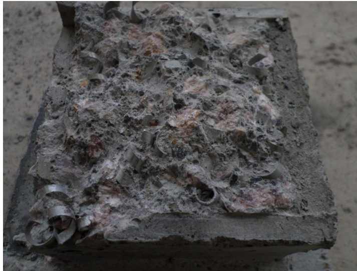
Figure II.43 : Faciès de rupture des éprouvettes.
