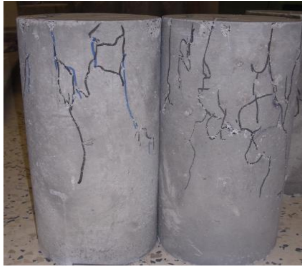
Figure II.16 : photo de l'éprouvette en béton renforcé avec W=0.8\% de fibres à 30 mm
