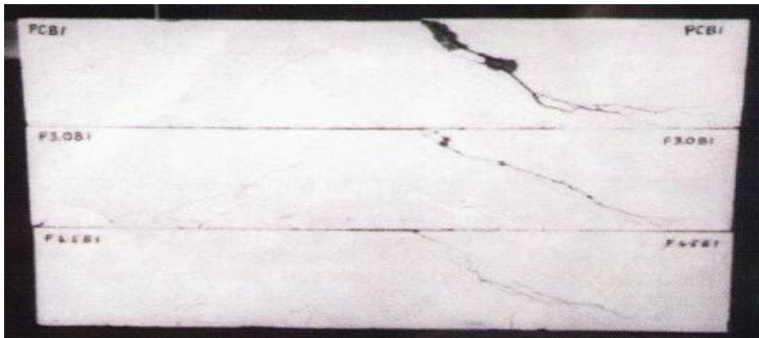
Figure I.55 : Mode de fissurations des poutres testées pour a/d= 24 [ROB. 82]
