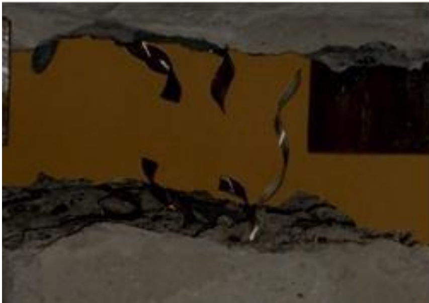
Etape 5 : les fibres sont rompues, les deux blocs de béton sont séparés.
