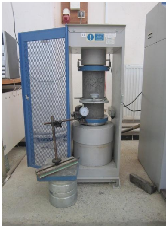
Figure II.8 : Dispositif de l'essai de compression
