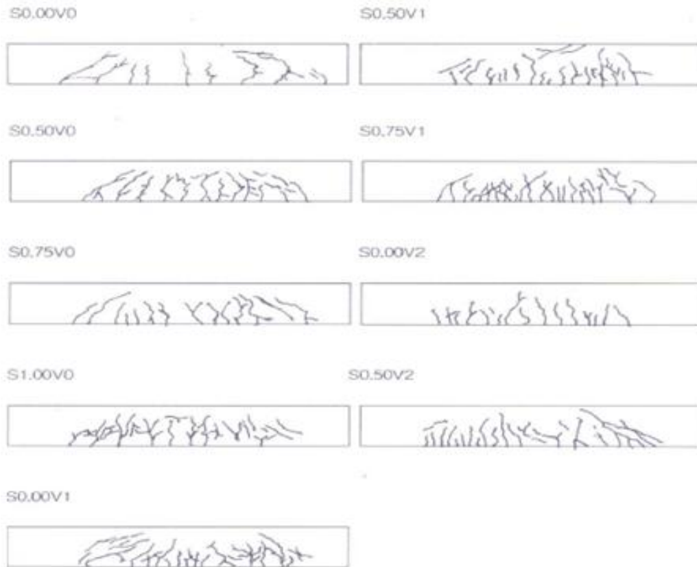
Figure I.41 : Mode de fissuration pour les différentes poutres testées [LIM. 99]
