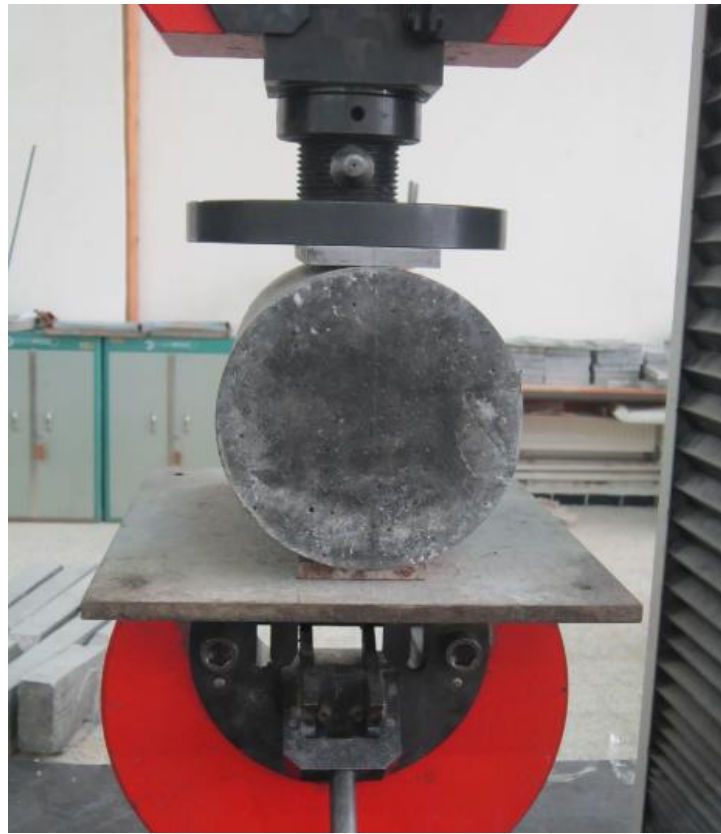
Figure II.33 : Dispositif expérimentale pour l'essai de fendage
