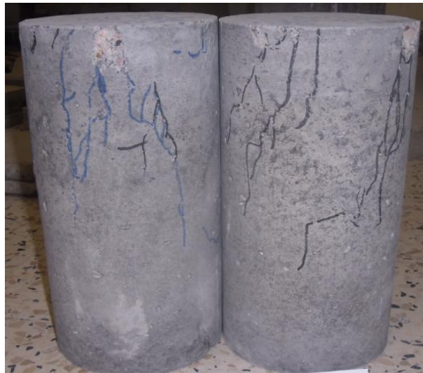
Figure II.17 : photo de l'éprouvette en béton renforcé avec W=1\% de fibres à 30 mm
