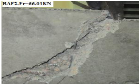
Photo 3 : rupture de la poutre BAF2 : Rupture à l'effort tranchant par cisaillement diagonale et rupture du cadre – ouverture franche de la fissure diagonale.
