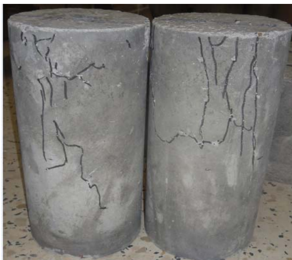
Figure II.15 : photo de l'éprouvette en béton renforcé avec W=0.6\% de fibres à 30 mm
