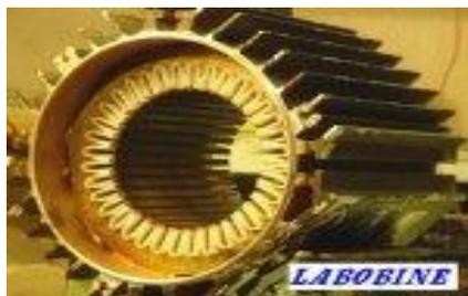
**Figure (I- 18):stator d'un moteur asynchrone triphasé [9].**
