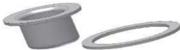
Figure II.13 : Opération de détourage
