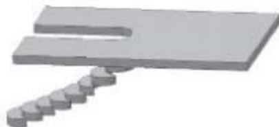
Figure II.11 : Opération de grignotage
