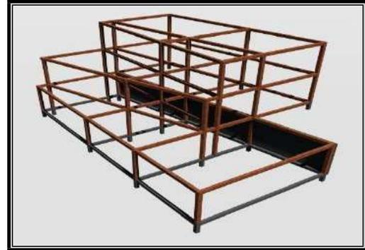
**Figure 146 et 147 :** Ossature de bois en portique en bois massif.
