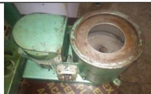
**Figure 7 :** centrifugeuse verticale.
