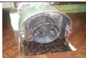
**Figure 5 :** broyeur à marteau.
