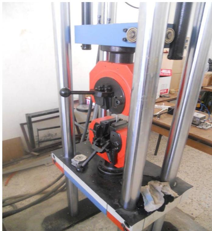
**Figure II.8 :** Machine de traction utilisée dans les essais de traction
