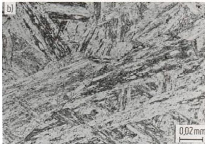
**Figure I.2 :** Microstructure des aciers inoxydables martensitiques.
