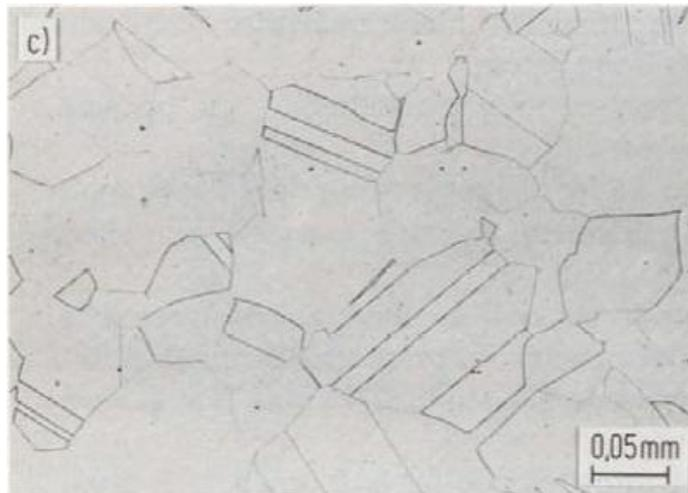
**Figure I.3 :** Microstructures des aciers inoxydables austénitiques.
