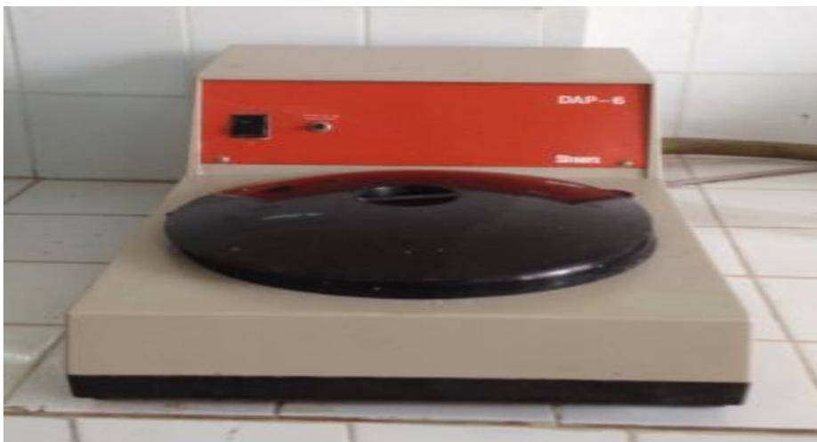
**Figure II.12**: Polisseuse mono disque de finition
