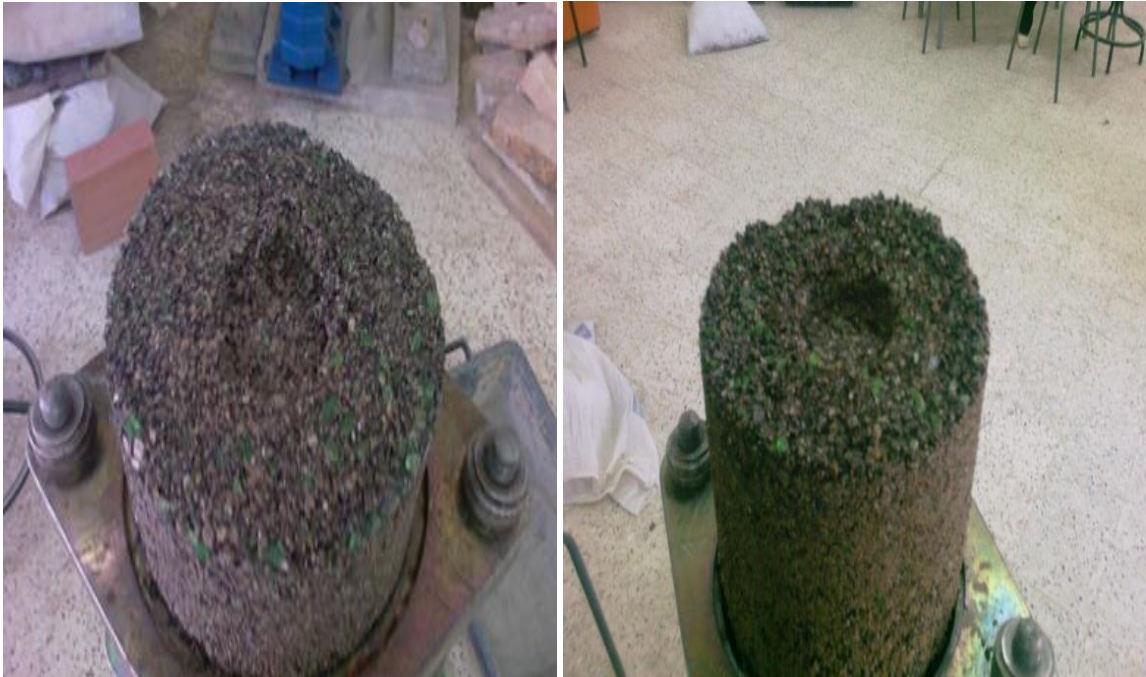
Figure 4..19. Eprouvettes du mélange sable +verre après poinçonnements.
