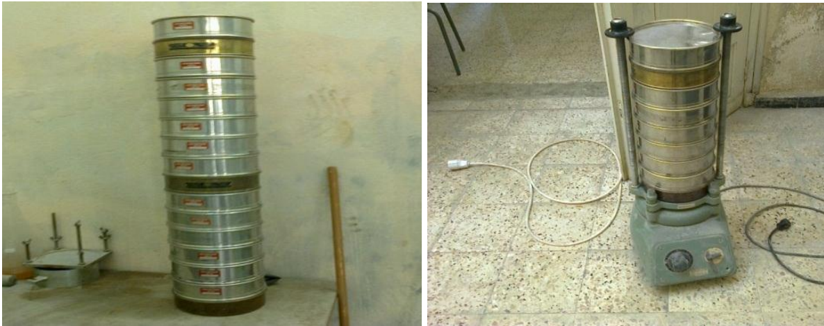
Figure 3.3 Exécution de l'analyse granulométrique par tamisage.
