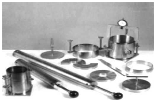
Moule Proctor, Dame Proctor, Règle à raser, Balance, Etuve, Eau et éprouvette graduée.
