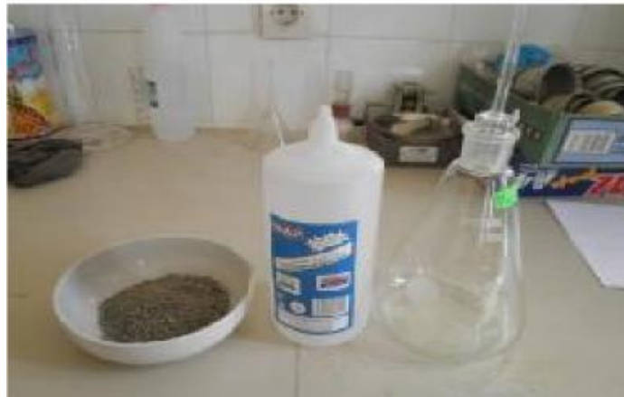
Figure 3.2 : matériels d'essai au pycnomètre.
