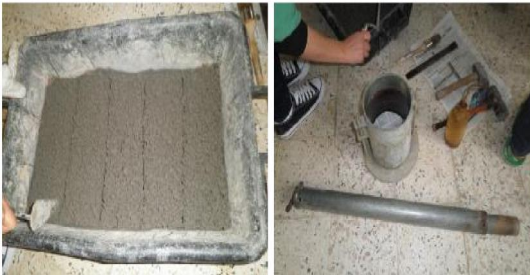
Figure 4.16. Matériel de confection des éprouvettes d'essai CBR.
