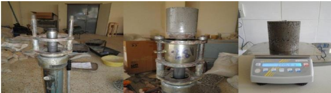
Figure 4.6. Etape de démoulage du moule Proctor.
