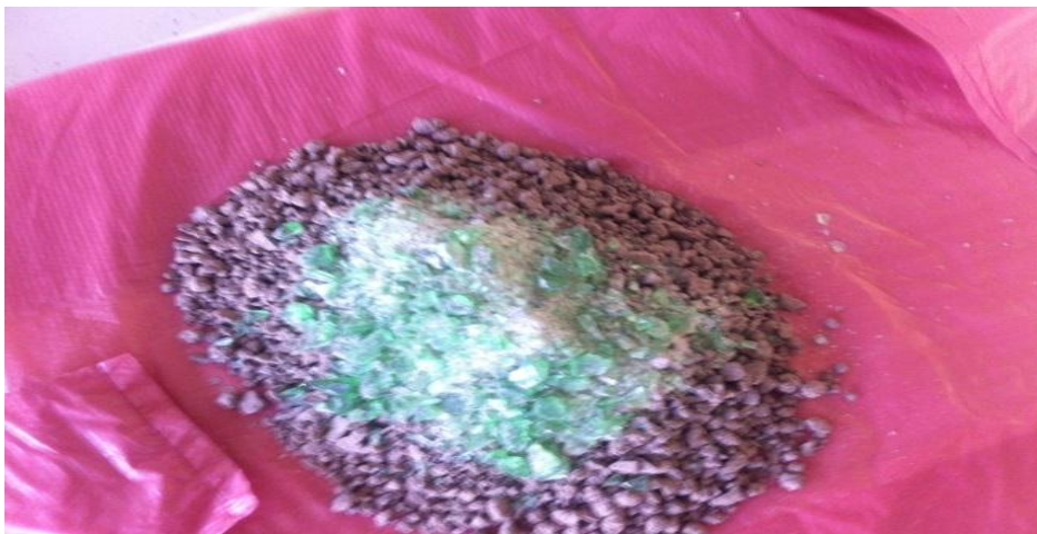
Figure 3.1 Mélange du sable routier avec des débris du verre d'emballages.
