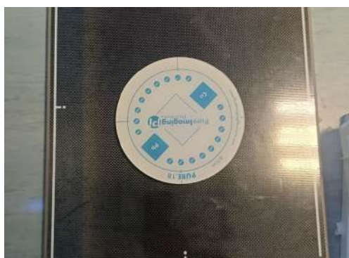
FIGURE 3.27 – Configuration expérimentale de test de détectabilité de faible contraste et résolution spatiale
