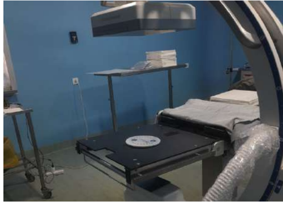
FIGURE 3.35 – Disposition expérimentale des deux évaluations :détection de contraste faible et résolution spatiale
