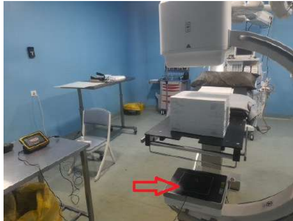
FIGURE 3.32 – Configuration expérimentale de test débit de kerma dans l'air à la surface de récepteur d'image
