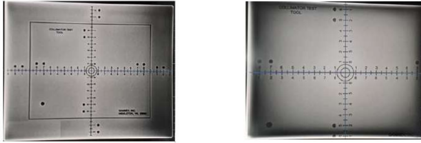
FIGURE 4.3 – Résultats test d’alignement de champs lumineux champs d’irradiation de deux tailles différentes de champs
