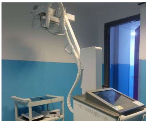
FIGURE 3.26 – Configuration expérimentale de test de linéarité mAs et dose
