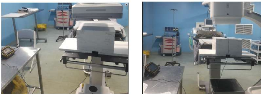
FIGURE 3.31 – Configuration expérimentale de test de débit de kerma à la surface d'entrée de patient
