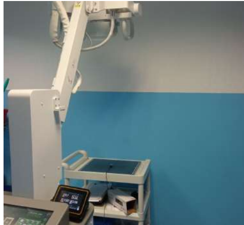
FIGURE 3.25 – Configuration expérimentale de test de précision de tube
