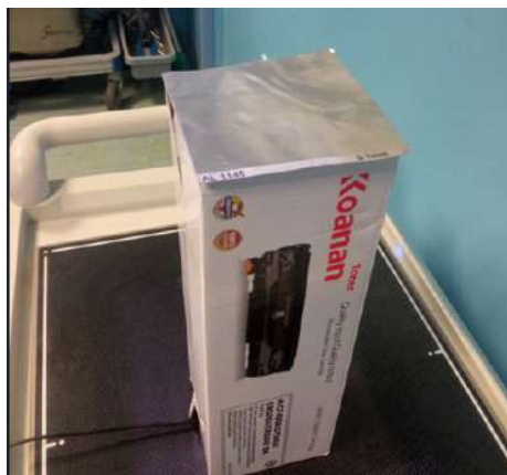
FIGURE 3.24 – Configuration expérimentale de test de couche de demi-atténuation
