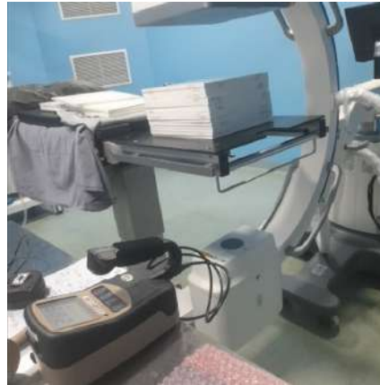
FIGURE 3.34 – Configuration expérimentale pour la mesure du rayonnement diffusé
