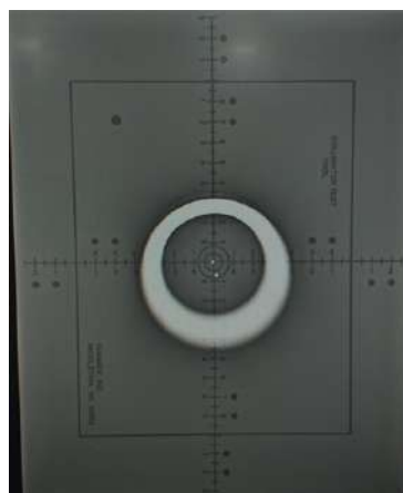
FIGURE 4.4 – Résultats de test de centrage de champs lumineux/ champs d’irradiation en radiographie mobile
