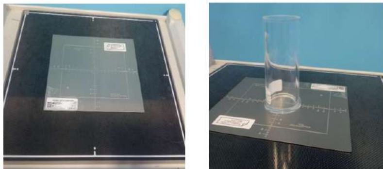
FIGURE 3.22 – Configuration expérimental de test d'alignement et centrage de champs lumineux champs d'irradiation
