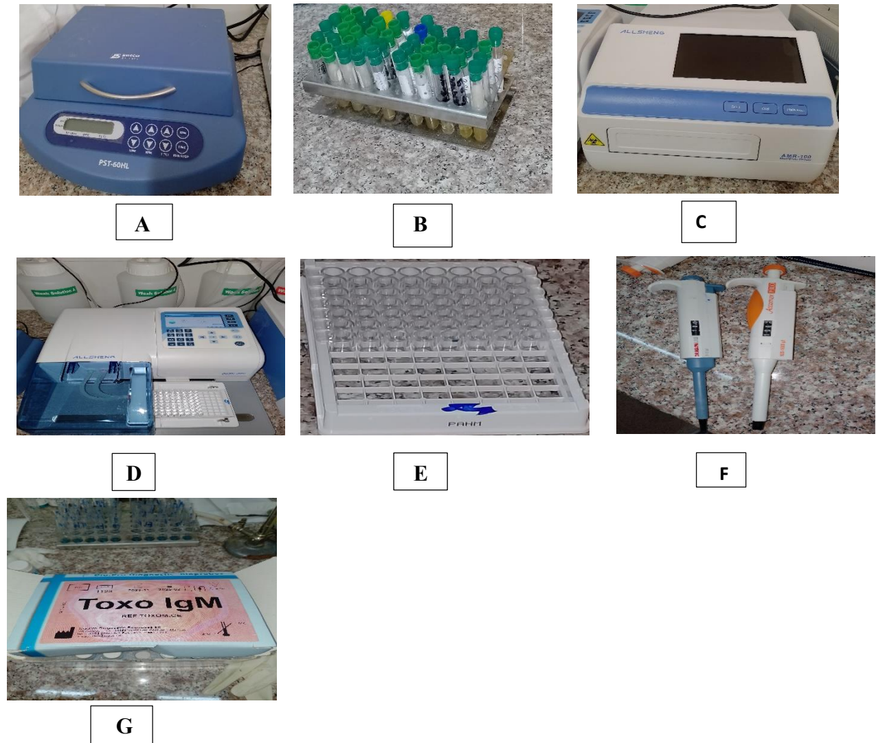
Figure 19 : Matériel de la pratique (A) incubateur. (B) sérum humain (échantillon). (C) spectrophotomètre. (D) laveur de microplaques. (E) microplaque. (F) micropipettes réglables. (.G) coffret de réactifs Anticorps anti- toxoplasma gondii IgM (Originale, 2024).
