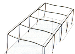
Cadre à nœuds rigides (stabilisation par effet cadre)
