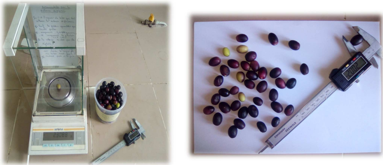
Figure 05 : Mesure pomologique des olives avec une balance analytique et un pied à coulisse (photo original, 2019).
