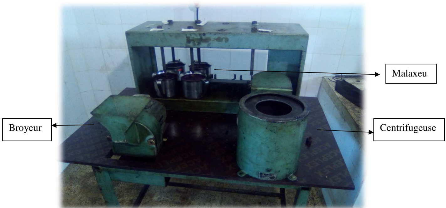
Figure 07 : Photographie de l'oléodoseur : système à deux phases (Broyeur, Malaxeur, Centrifugation).
