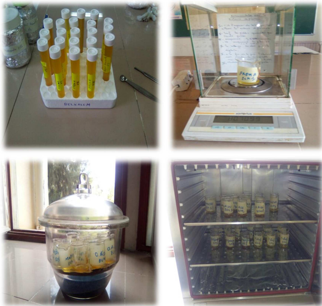
Figure 08 : Différentes étapes de détermination du taux d'humidité de l'huile d'olive (photo originale, 2019).
